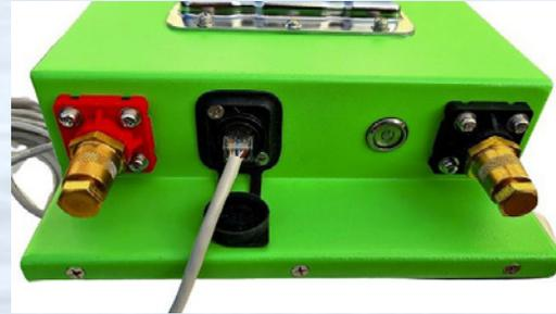
Für eine schnelle Kontrolle aller Batteriedaten, kann mit der RS485 Schnittstelle eine optionale „Fernbedienung“ Datenmonitor angeschlossen werden.
